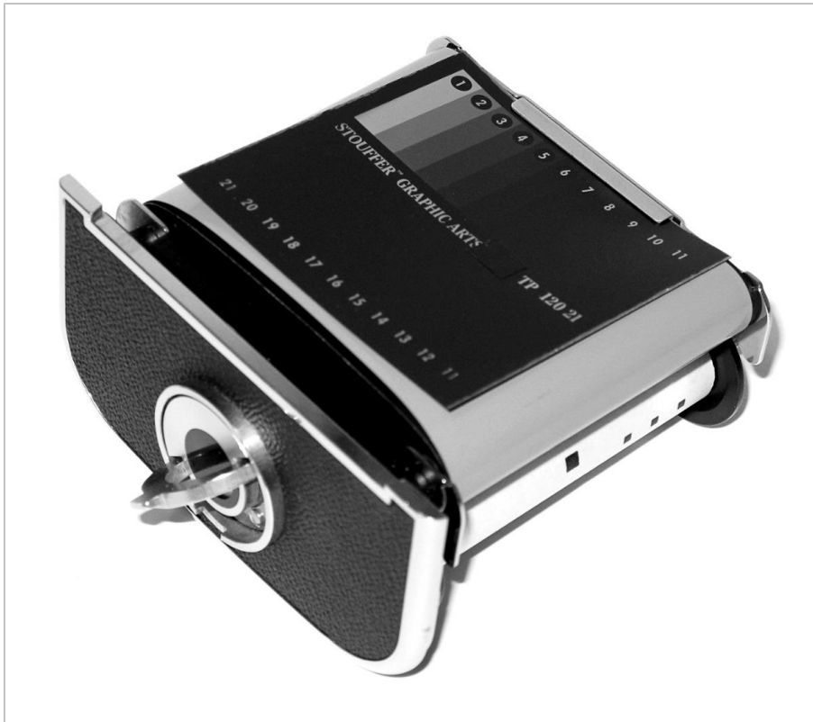
Abbildung 2: Testnegativ in Magazinhalter eingesetzt
